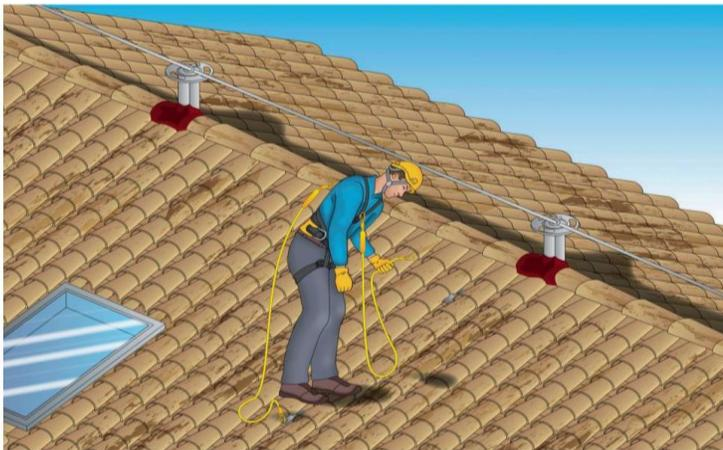
Figura 3 - Esempio di ancoraggio puntuale permanente
